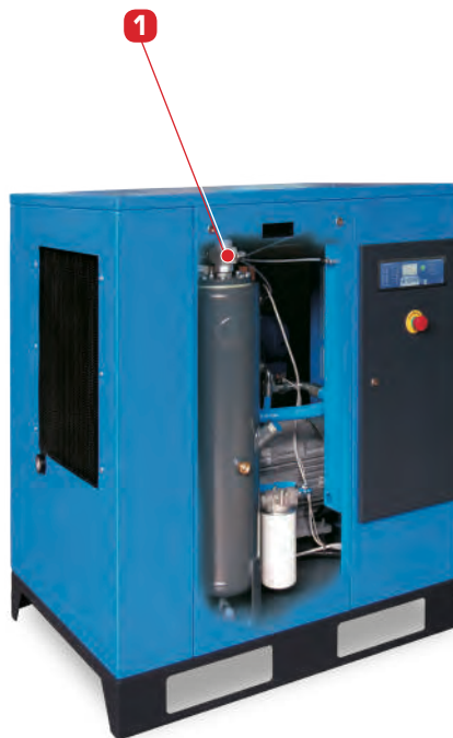
1 Sistema di separazione aria-olio.
